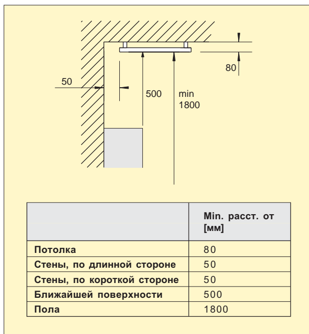
Рисунок. 2: Минимальные расстояния при установке.
